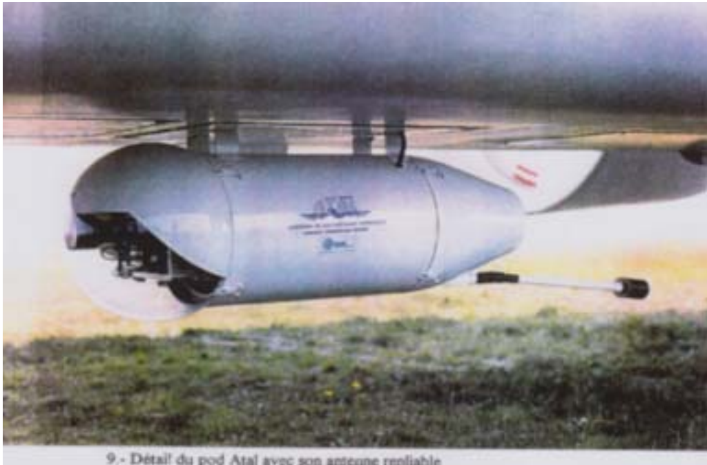
9.- Détail du pod Atal avec son antenne rétractable
