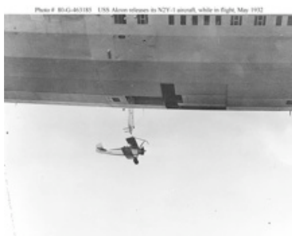
Avion Sparrowhawk accroché sous le portique de ramassage de l'Akron
