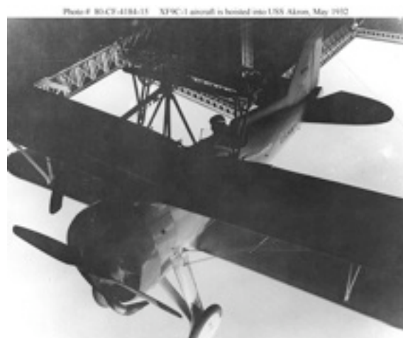
Avion Sparrowhawk en cours de remontée dans le hangar aviation de l'Akron
