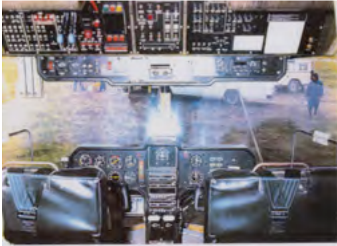
14 - Contrôle des pressions et températures d'air et d'hélium
