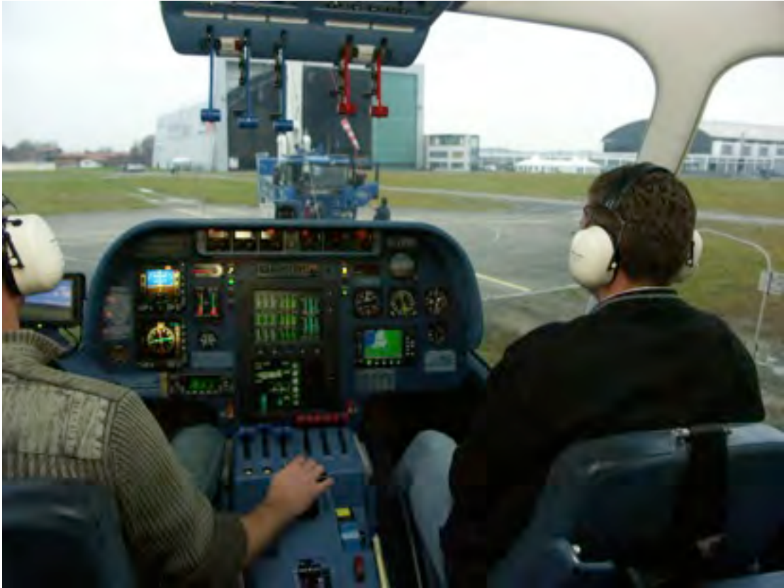
Vue du poste de pilotage du Zeppelin NT : on remarquera la simplicité de l'instrumentation par rapport à celle d'un Skyship 600 des années 80/
