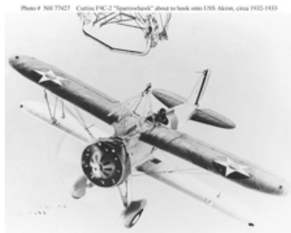
Avion Curtiss Sparrowhawk se présentant sous le portique de ramassage de l'Akron (Il s'agit pour le pilote de réaliser une manœuvre d'appontage inversée)
