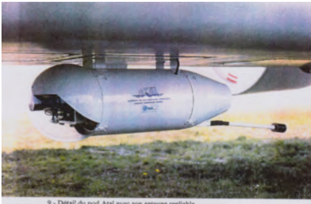
9.- Détail du pod Atal avec son antenne renliable
