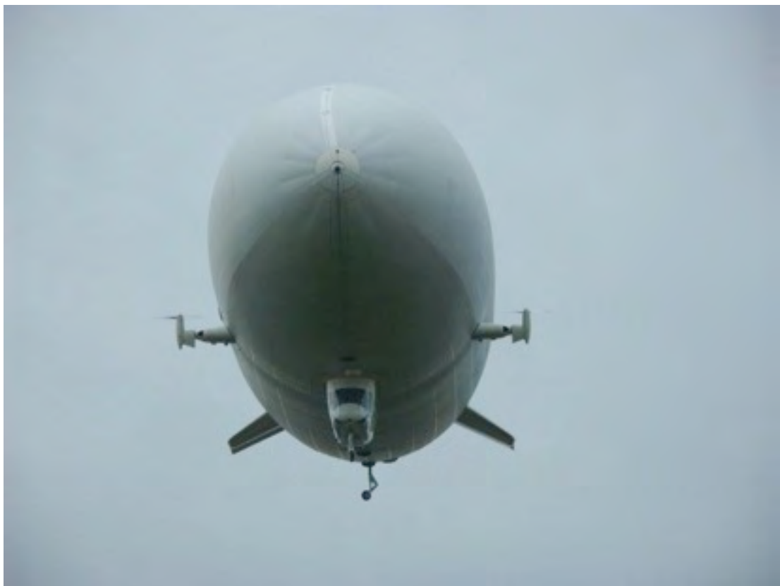
Vue d'un Zeppelin NT en manœuvre d'atterrissage, hélices orientées vers le haut
