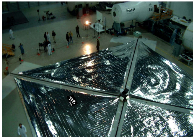
Déploiement complet de la voile solaire (20 x 20 m = 400 m 2 )
