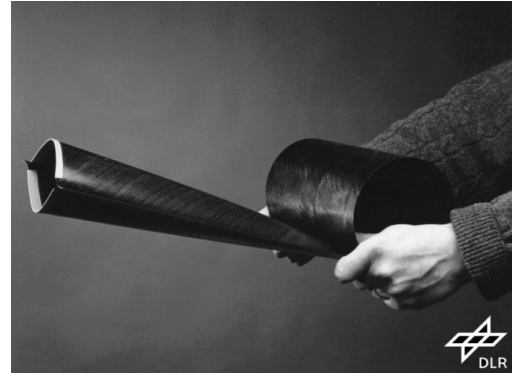
Déploiement des mâts en fibre de carbone
